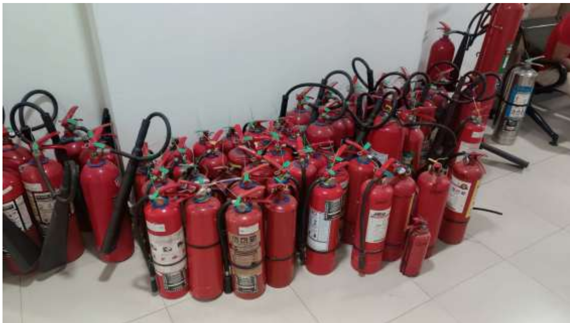
Ilustración 14: Extintor de polvo químico seco y de carbono recargados, dpto. de Riesgo del Gad. Daule
